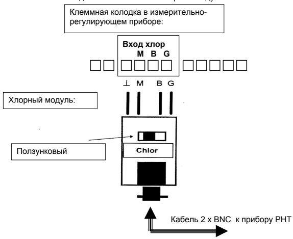
Подсоединить хлорный модуль посредством адаптерного кабеля и C. уголкового штекера, установленного на приборе РНТ, к прибору РНТ.
