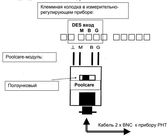
**c.** Соединить модуль Poolcare при помощи адаптерного кабеля и углового штекера к PHT-тестеру.
