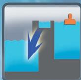
Управление переливной емкостью для бассейнов с переливным желобом, по принципу гидростатического измерения высоты уровня.
