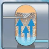
Автоматическая промывка фильтра с вентилями размером 1 1/2", 2" и 3" с возможностью вывода процесса на дисплей.
