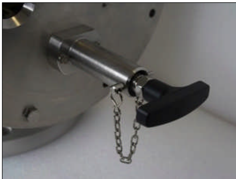
Фиксирующий штифт ручной системы очистки от налета в установленном положении
